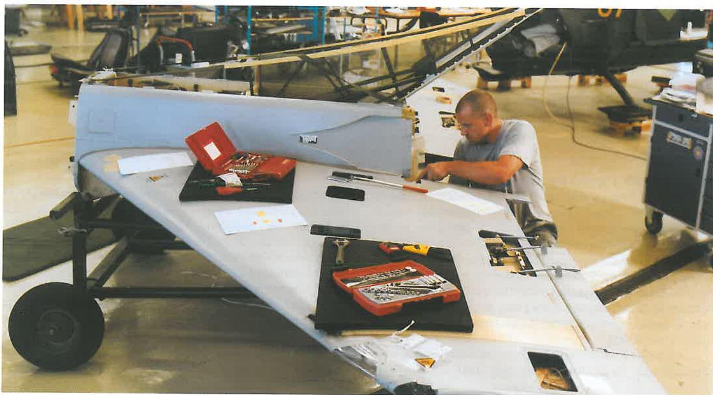
Plåtslagare Shane Dunn åtgärdar skrovet på den UAV som "donerat" enheterna till spaningskapseln.
